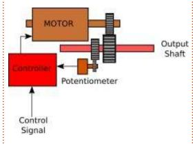
Les signaux de commande sont attendus sous une « forme » très spécifique et nous utiliserons PWM (Pulse Width Modulation - Modulation de largeur d'impulsion) pour cela. D'abord. les impulsions doivent arriver toutes les 20 millisecondes. La largeur de l'impulsion détermine dans quel sens tourne l'axe de sortie. Si l'impulsion est large de 1 ms, le moteur tournera jusqu'à 0°. Si l'impulsion est de 1,5 ms, alors l'axe tourne jusqu'à 90°. Si l'impulsion est de 2 ms, l'axe tourne iusau'à 180°.
