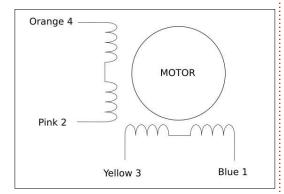
Les numéros montrés avec les couleurs des fils sont pour le 28BJY et les vôtres peuvent être différents. Le connecteur des fils (s'il y en a un) peut être différent d'une unité à l'autre. Vous pouvez utiliser un ohmmètre pour tester les bobines.
