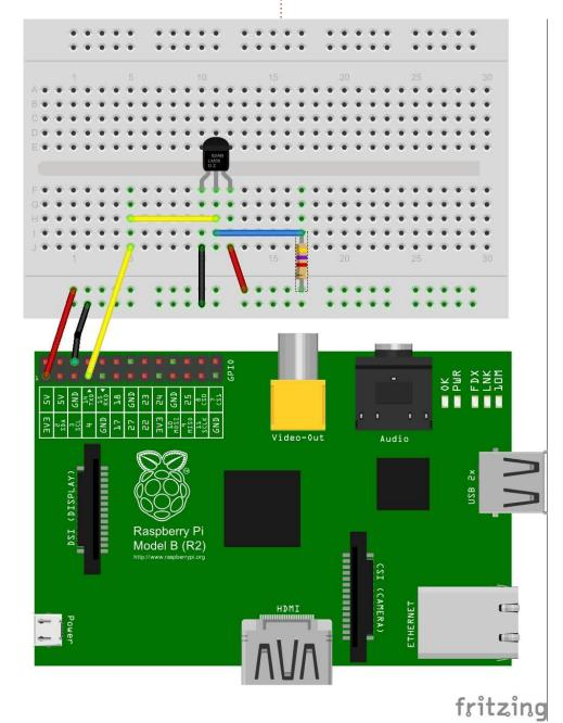
Les deux commandes suivantes chargent les pilotes du 1-fil et du thermomètre sur GPIO 4.
