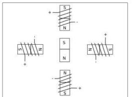
Alimenter chaque bobine, une à la fois, va faire que l'aimant du rotor va se tourner vers la bonne bobine. Si on se quide sur un cadran d'horloge, alimenter les bobines successivement à 12 h, 3 h, 6 h, 9 h, puis de nouveau 12 h
