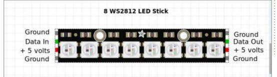
de la plaque d'essai. La broche d'entrée des données de la barre de LED est connectée à la broche physique 21, qui est le GPIO 16. Les broches de masse et de +5 volts de la barre sont également connectées aux rangées d'alimentation de la carte d'essai. Enfin, j'ai décidé d'utiliser la broche n° 27 veillez à connecter la rangée de la masse à une broche de masse du Pico. Il est important que tous les appareils partagent une référence de masse commune.
