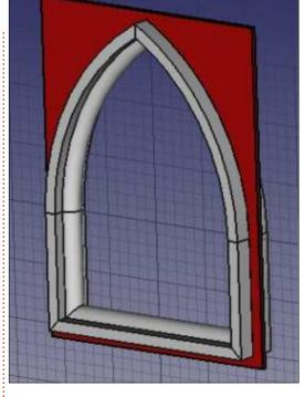
eu besoin aussi de déplacer la seconde esquisse un peu vers le bas d'environ 25 mm -, probablement pour m'assurer qu'elle n'était pas dans le voisinage d'un pont de connexion entre les segments de notre esquisse de l'arcade.
