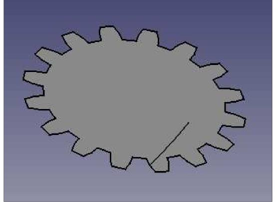
pouvez sélectionner la forme Hélice. Comme je souhaite créer un engrenage de 50 mm d'épaisseur, avec des révolution pour créer les évidements dents penchées à environ 1:20 sur l'épaisseur de la roue, je choisis une hauteur d'hélice de 50 mm, mais un ET ENSUITE? axe de tangage de 1000 mm entre les spires de l'hélice. Le rayon extérieur de l'hélice devrait correspondre à celui du point où elle sera créée. Des hélices à pas droit ou gauche peuvent être utilisées, suivant le besoin.
