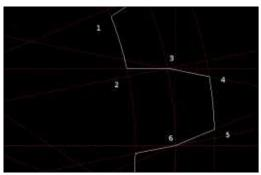
une limite extérieure, le plat sommital. Les points 4 et 5 sont sur ce rayon, fixé à 110 mm dans notre cas. Enfin, nous avons besoin de dégager de la place vers l'intérieur pour laisser passer les dents de l'autre roue. Aussi, nous allons vers l'intérieur jusqu'au fond plat, à un rayon de 90 mm dans notre cas, et obtenons les points 1 et 2. Nous répéterons cette forme de base sur les 16 dents de notre roue.
