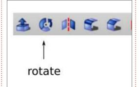
Assurez-vous de sélectionner l'axe X pour tourner autour, car l'objet tube est symétrique par rapport à l'axe horizontal. De même, activez la case « Créer solide ». Ceci nous permettra d'utiliser ensuite cette pièce comme un objet complet et de faire des trous dedans pour permettre le branchement du morceau de tube latéral.
