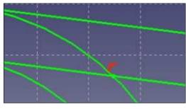
Une fois créés les points de l'intersection, les lignes dans l'atelier Draft peuvent être aimantées à ces points si l'option « Aimanter à une intersection » est choisie (l'icône avec un X vert dans la barre d'outils d'aimantation).
