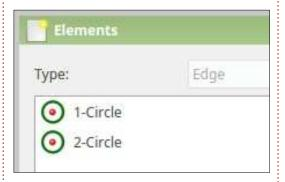
Une fois les deux cercles créés, nous pouvons inspecter le nombre d'éléments créés dans la fenêtre « Éléments » et sélectionner chacun en cliquant dessus.
