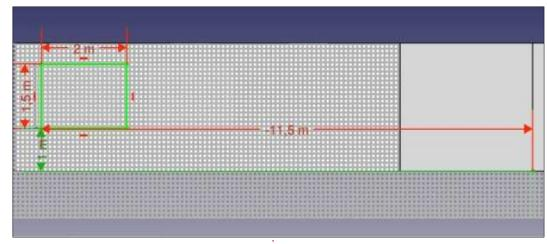
formez le Sketch en objet fenêtre. Dans la vue combinée sur la gauche, vous devriez voir maintenant que l'objet Mur d'origine (Wall004) a été remplacé par un nouveau mur (Wall006) qui contient à la fois la forme d'origine et un nouvel objet Fenêtre. Ce dernier objet contient à son tour le Sketch. Chaque objet interne définit la forme de l'objet externe qui le contient.
