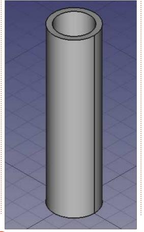
Puis, en utilisant la vue combinée à gauche, choisissons le premier cylindre et allons dans la partie basse marquée « Données ». Ici, changez le rayon pour 13 mm et la hauteur pour 100 mm. Ce sera la partie solide de notre nouveau tube.
